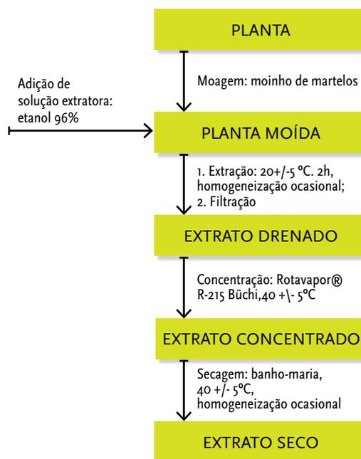
FIGURA 1 Fluxograma geral do processo de produção.
