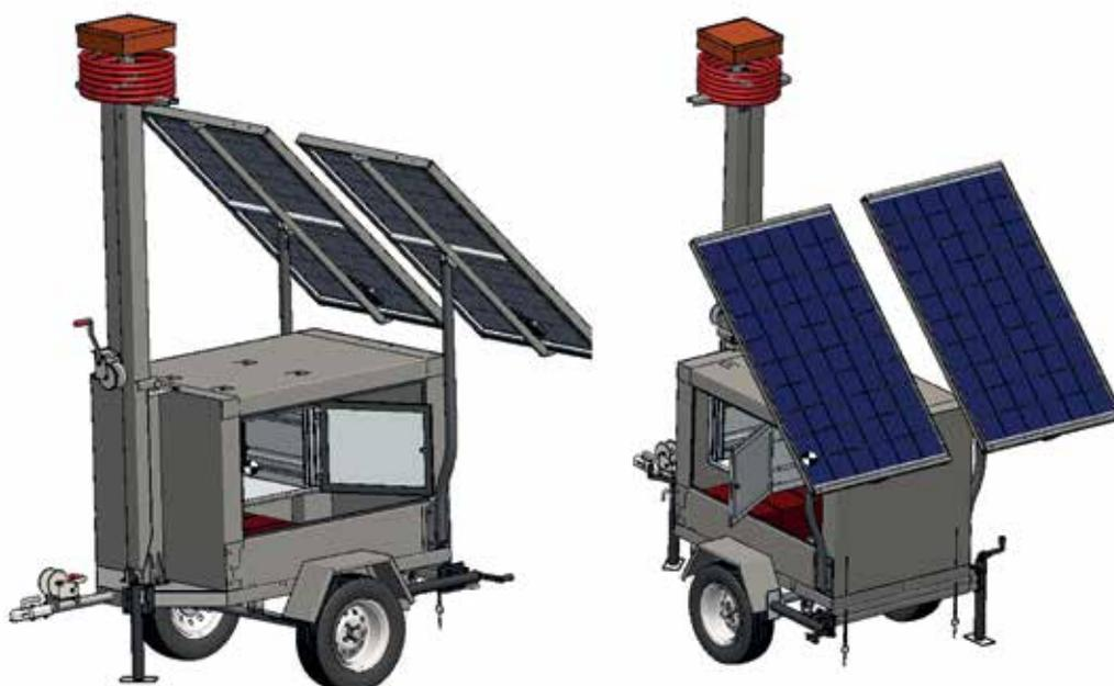
FIGURA 5 - Primeiro protótipo: vista lateral direita e vista frontal
